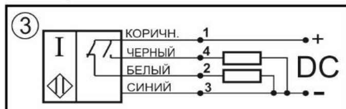
Схема соединения Переключающий контакт
